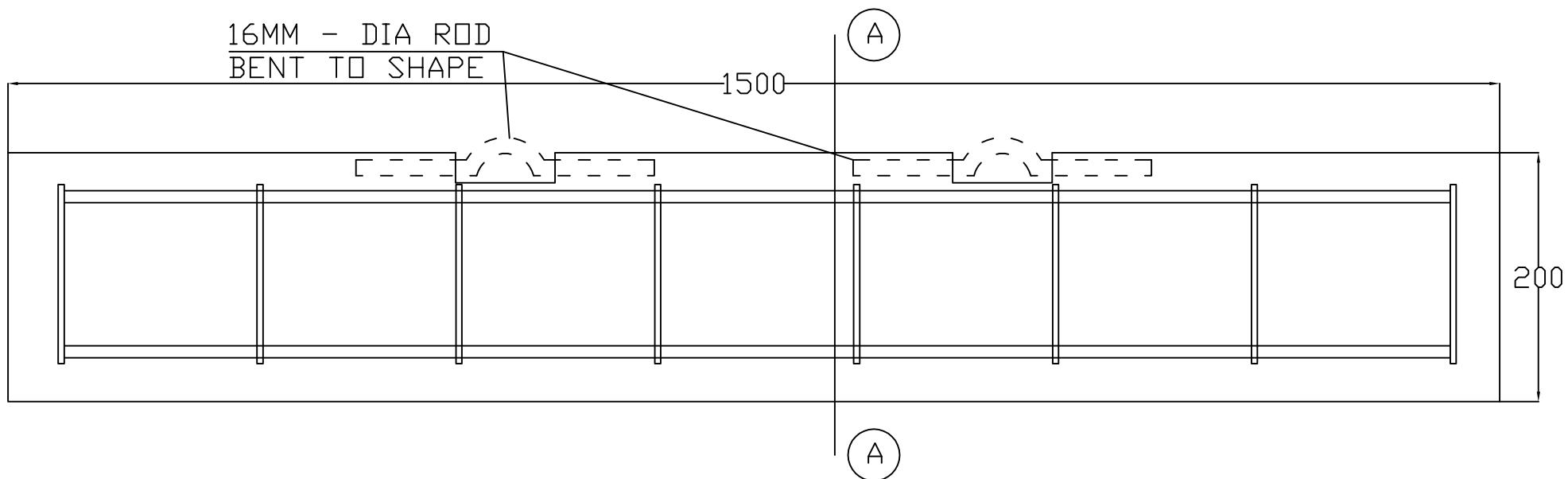
LONGITUDINAL SECTION OF CONCRETE SLEEPER
