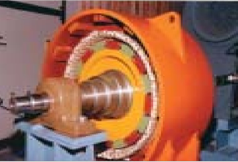
कारपोरेट अ. और वि. में बीएचईएल द्वारा विकसित 38 कंडब्ल्यू स्थायी चुम्बक जेनरेटर
