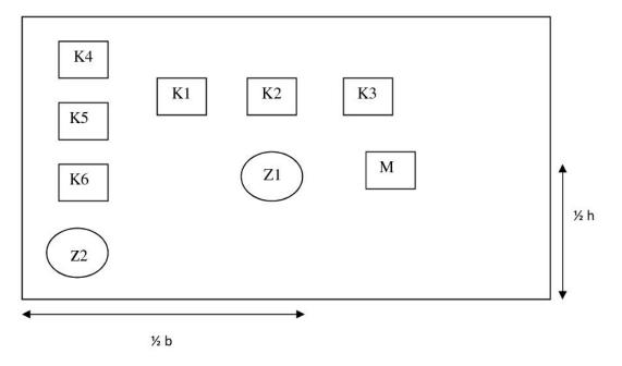
Z1, Z2 = TENSILE SPECIMENS (LONGITUDINAL DIRECTION)
