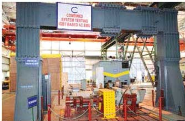
बीएचईएल, सोपल में विद्युत परिवहन केंद्र पर आईजीबीटी आधारित एसी ईएमयू का संयुक्त प्रणाली परीक्षण
