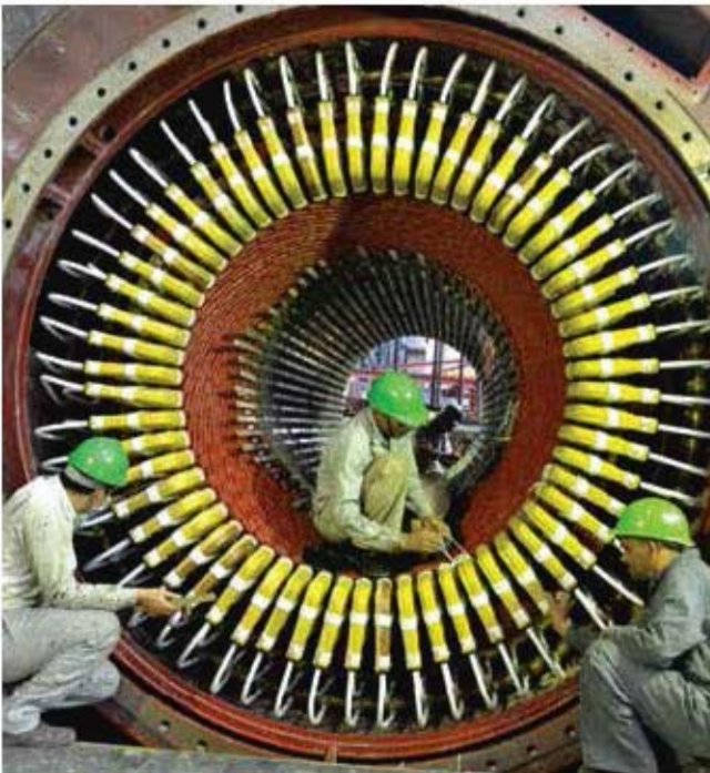
बीएचईएल, हरिद्वार में स्टेटर निर्माण प्रगति पर
