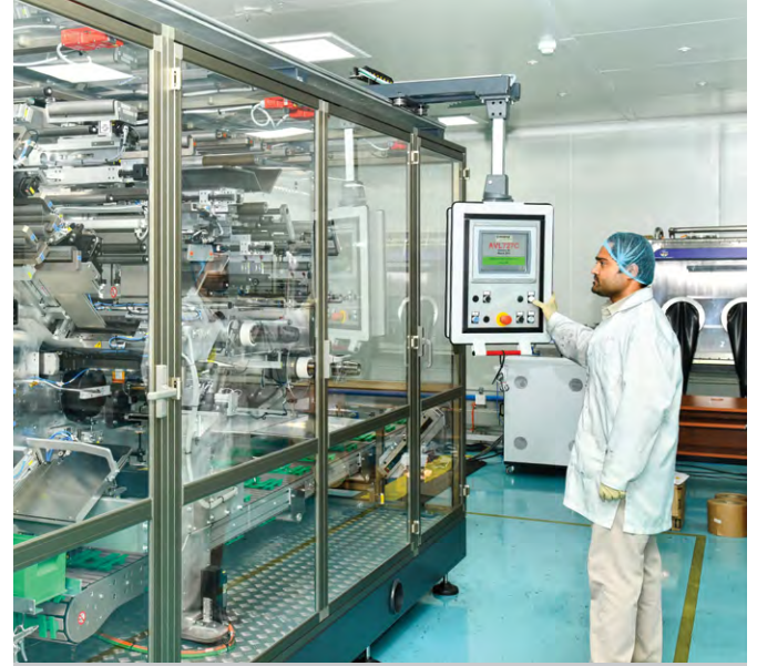
इलेक्ट्रॉनिक सिस्टम्स डिवीजन बेंगलूरु में लिथियम-आयन सेल का विनिर्माण
