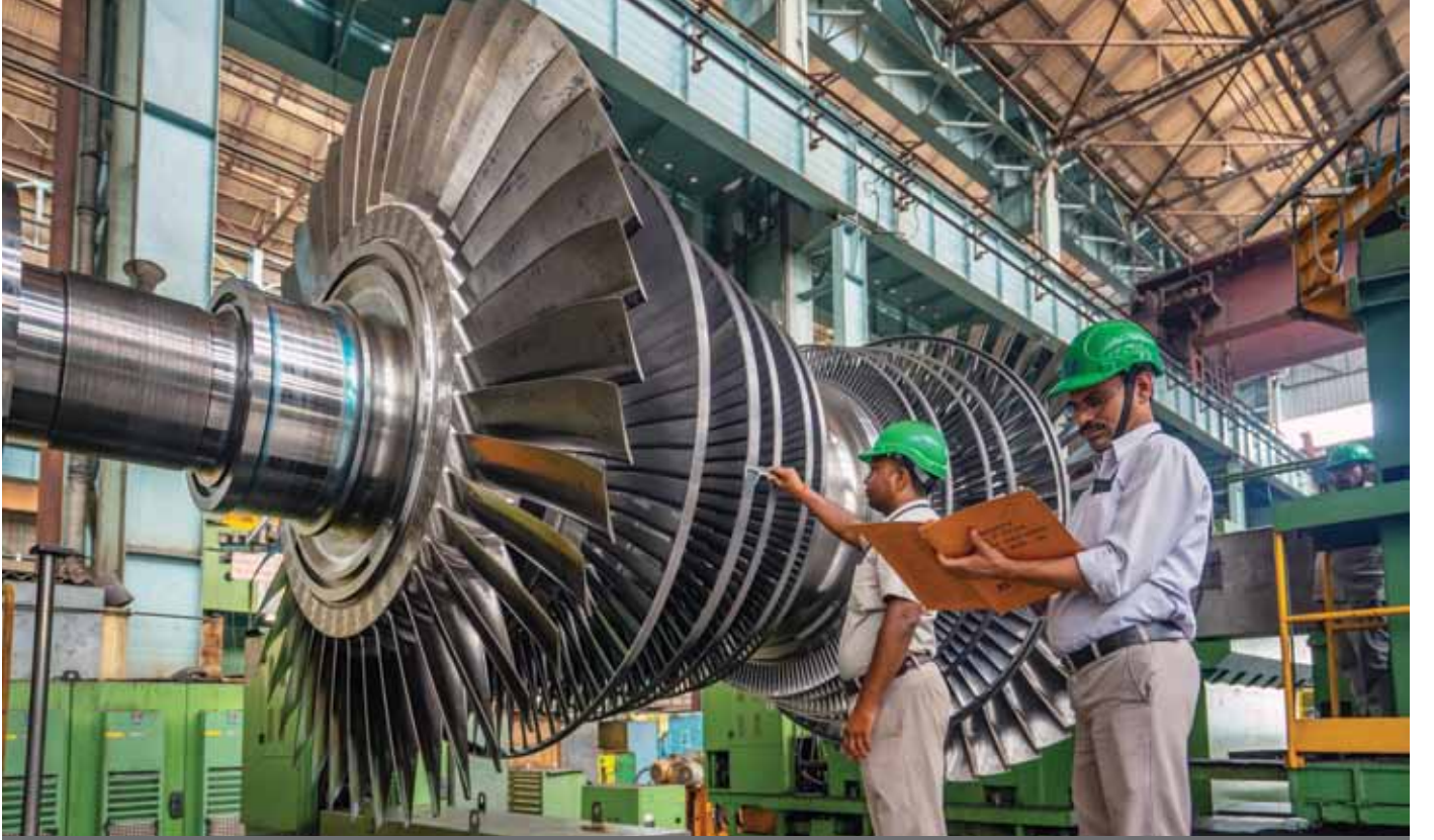
भेल हरिद्वार की न्यू टरबाइन शॉप में निरीक्षण के तहत 800 मेगावाट एलपी टर्बाइन
