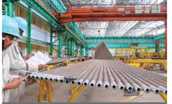
बीएचईएल तिरुचिरापल्लि में सुपर-क्रिटिकल बॉयलर के लिए स्पाइरल वॉटर वॉल असेम्बली प्रगति पर
