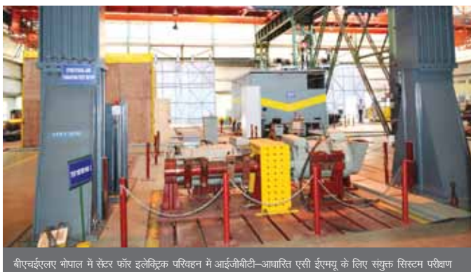
बीएचईएल ने भोपाल में सेंटर फॉर इलेक्ट्रिक परिवहन में आईजीबीटी-आधारित एसी ईएमयू के लिए संयुक्त सिस्टम परीक्षण
