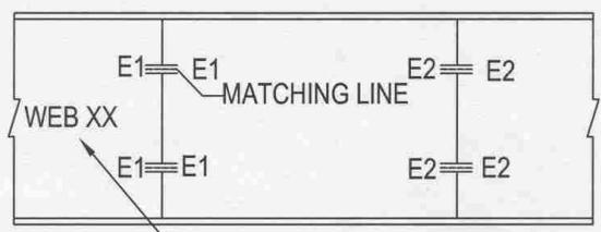
POSITION OF ALL WELDED BEAMS TO BE MARKED ON THE WEB
